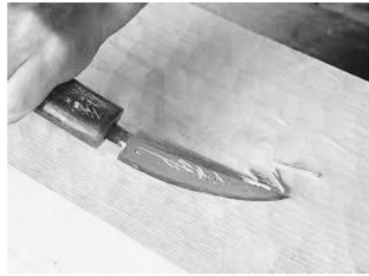
写真 20 ヤリガンナの使用例 ※右は荒木昌平氏、左は佐藤正裕氏の実演
