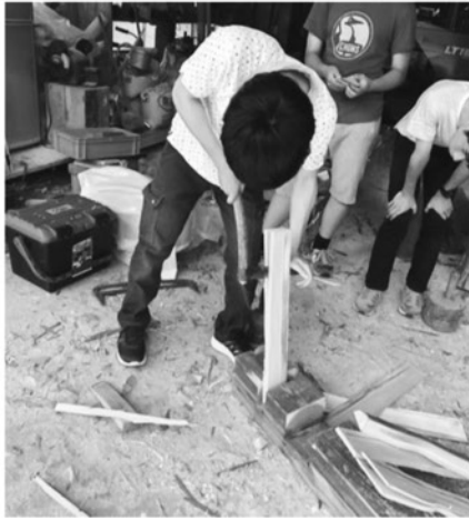
写真1 樽板（屋根板）の製作
